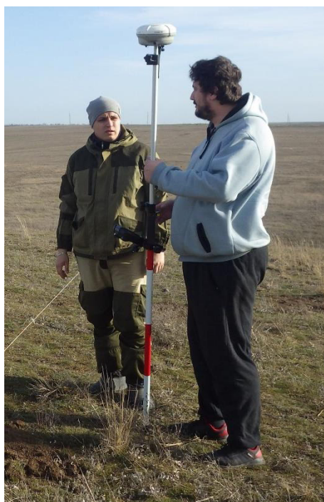
Рис. 3. Работа с дифференциальным GPS приемником Trimble R8 на поселении Каймак-1
