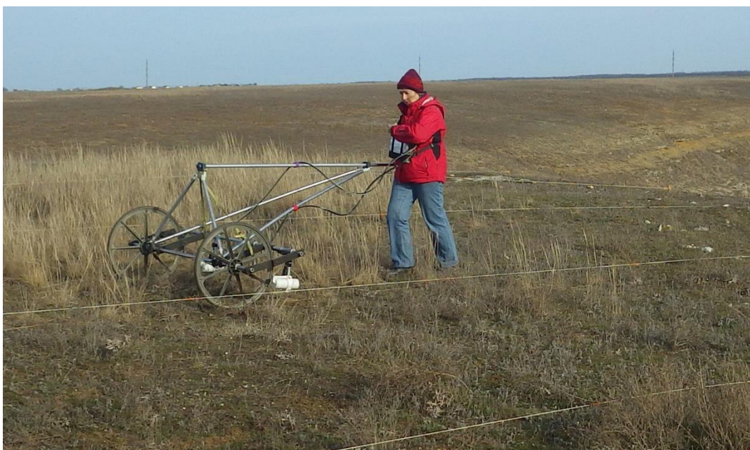
Рис. 2. Магниторазведка с использованием двухдатчиковой системы на базе канадского магнитометра GSM-19WG фирмы GemSystems на поселении Каймак-1
